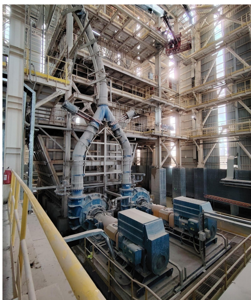
2-rasm. Sharli tegirmon va unga xizmat ko'rsatuvchi sanoat maydonchasi. Taqdim etilgan yuqori aniqlikdagi fotosurat [8].
